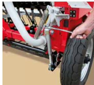
Réglage centralisé du terrage
