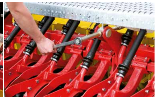
Réglage du terrage centralisé – terrage jusqu'à 50 kg/rang
