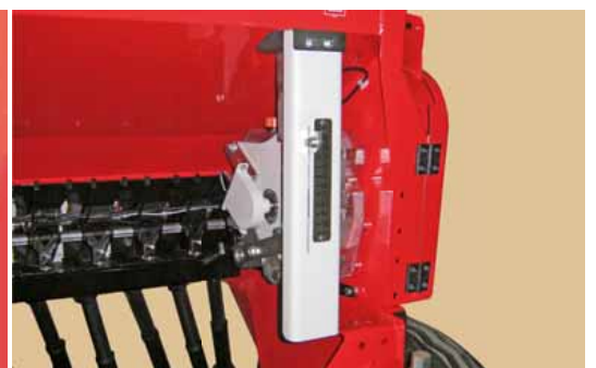
Modulation électrique du débit
