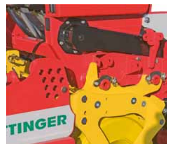
Założyć ramie mocujące i zabezpieczyć siewnik.
