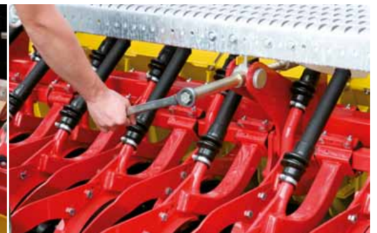
Centralna regulacja nacisku redlic – do 50kg nacisku
