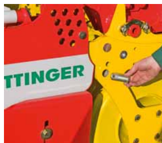
Wyciągnąć sworznie blokujące z wału – prowadzenie w równoległoboku
