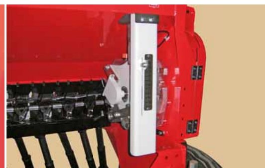
Электронная настройка массы высева
