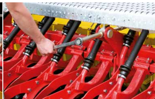
Центральная регулировка давления сошников – до 50 кг
