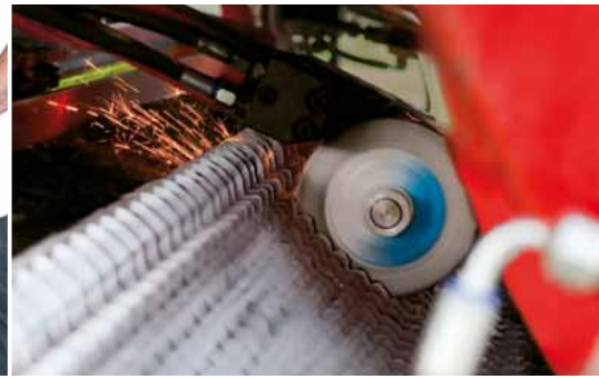
AUTO CUT – Vollautomatische Messerschleifeinrichtung direkt am Ladewagen.
