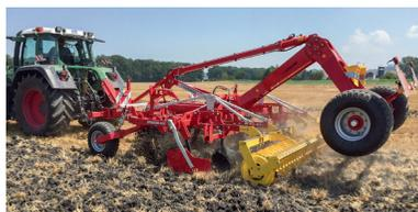
Während dem Feldeinsatz bleibt das Transportfahrwerk angehoben und übt somit eine zusätzliche Belastung auf die Arbeitswerkzeuge.
