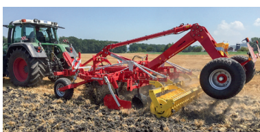
Le châssis est relevé lorsque la machine travaille, exerçant ainsi un poids supplémentaire sur les outils de travail.
