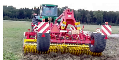
Le déchaumeur SYNKRO 4030 T de PÖTTINGER s'avère être très efficace pour détruire une prairie et préparer le sol pour la culture suivante.
