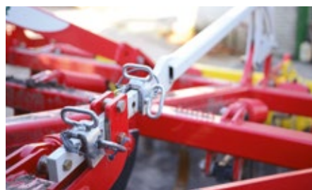
Regulacja pozycji wału, a w konsekwencji głębokości roboczej, dokonywana jest poprzez zmianę pozycji sworzni ustalających.
