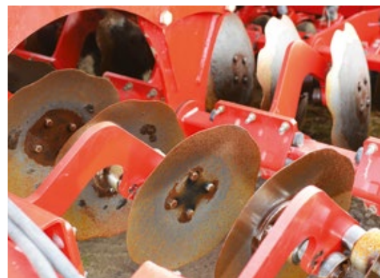
Przednia sekcja talerzy jest już dość mocno zużyta. Możliwość niezależnej regulacji głębokości obu sekcji pozwala zachować odpowiednią jakość pracy.
