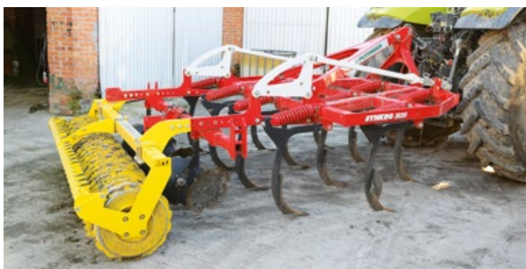
Kultywator Synkro o szerokości roboczej 3 m współpracuje z 210-konnym ciągnikiem. Na lekkich glebach, zdaniem Sławomira Popielnickiego, wystarczyłaby moc ok. 160 KM.
