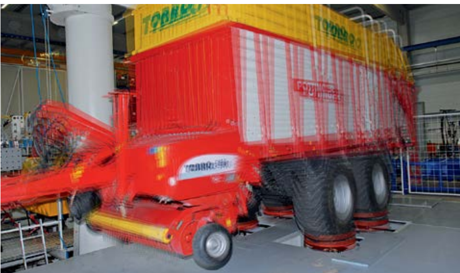
Wielkogabarytowa przyczepa samobierająca wprawiona w wibrację. W centrum testowym na 4-wspornikowym stanowisku można przeprowadzić symulację zużycia każdej maszyny podczas całego okresu użytkowania.
