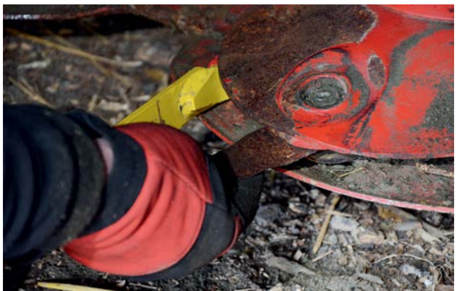
Koszenie 65 ha traw nie wymaga wymiany noży, z wyjątkiem skrajnych, które są w szczególnym stopniu narażone na kontakt z ziemią i kamieniami (miedze).
