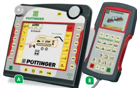
Kosiarka Novacat X8 jest kompatybilna z ISOBUS-em. Pomimo wyposażenia jej w komputer sterujący (A), Adam Paczowski korzysta z terminala ciągnika. Standardowym systemem sterowania jest Power Control (B).
