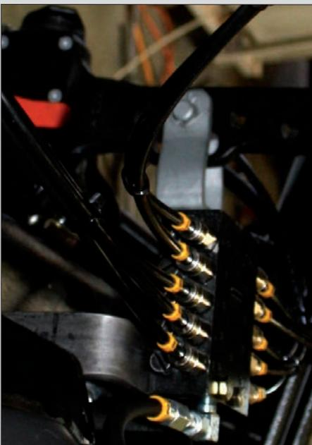
Achse starr mit 10 Schmierstellen über Progressivverteiler SSV 10\*
