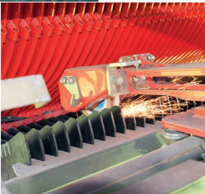
**Mit der automatischen Messerschärfleinrichtung lassen sich Zeit und Kraft sparen. Zudem bleibt die Schnittqualität gleich.**
