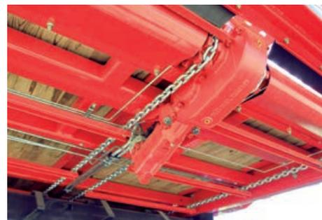
Der geteilte Kratzboden wird mit einem 2-stufigen Ölmotor hinten mittig angetrieben.
