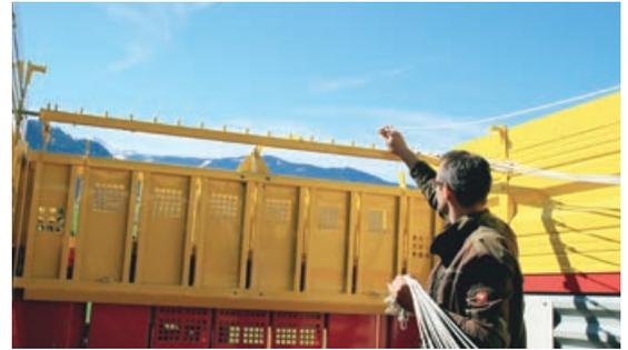
Die Dachseile für den Ladewagenbetrieb lassen sich einfach montieren.
