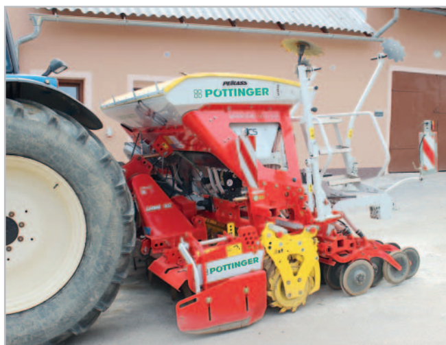
Secí stroj Aerosem 3002 ADD je agregován s rotačními bránami Lion 302 firmy Pöttinger. Předchůdcem rotačních bran bylo starší provedení Lion 301, využívané v podniku dlouhou dobu v kombinaci s mechanickým secím strojem
