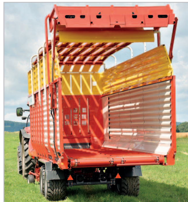
Velký úhel vyklopení zadní stěny a široký průřez ložné plochy v zadní části vozu umožňují jeho rychlé vyprázdnění. Ani při vykládání hmoty nemusí řidič opouštět kabinu, vše řídí automatika
