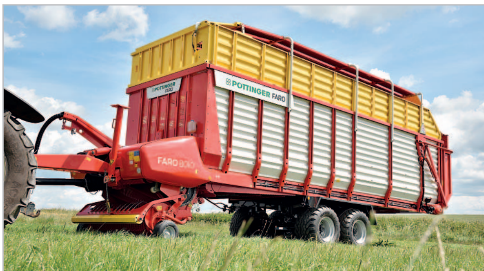
Celých 80 m 3 ložného objemu při středním stlačení na lehkém podvozku a s modernizovaným sběracím a plnicím ústrojím – to jsou nové návěsy Faro „desítkové“ řady firmy Pöttinger
