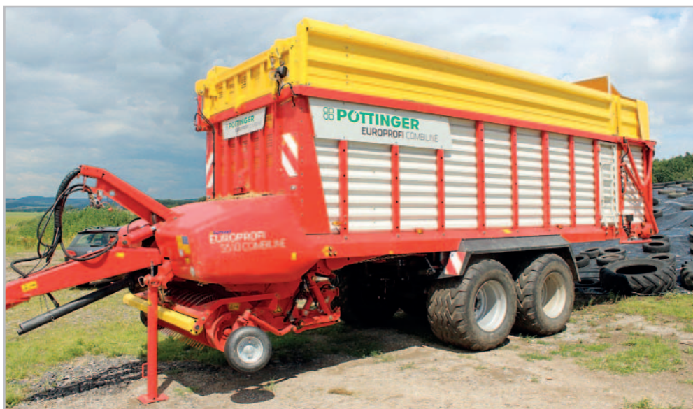
Kombinovaný návěs Europrofi 5510 L Combiline nachází v podniku VOD Lidmovice uplatnění jak při odvozu píce od rezačky, tak při sklizni hůře přístupných luk, kde je zcela samostatný
