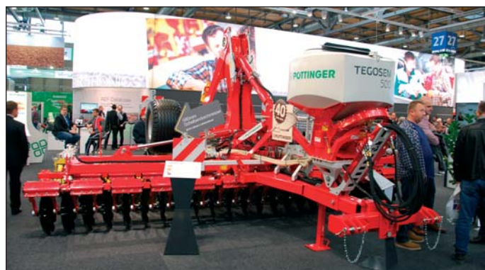
Tegosem – výsevný systém sa sejbou medziplodín. Tegosem je možné kombinovať s radličkovými kypričmi Synkro a diskovými podmietačmi Terradisc (na snímke).
