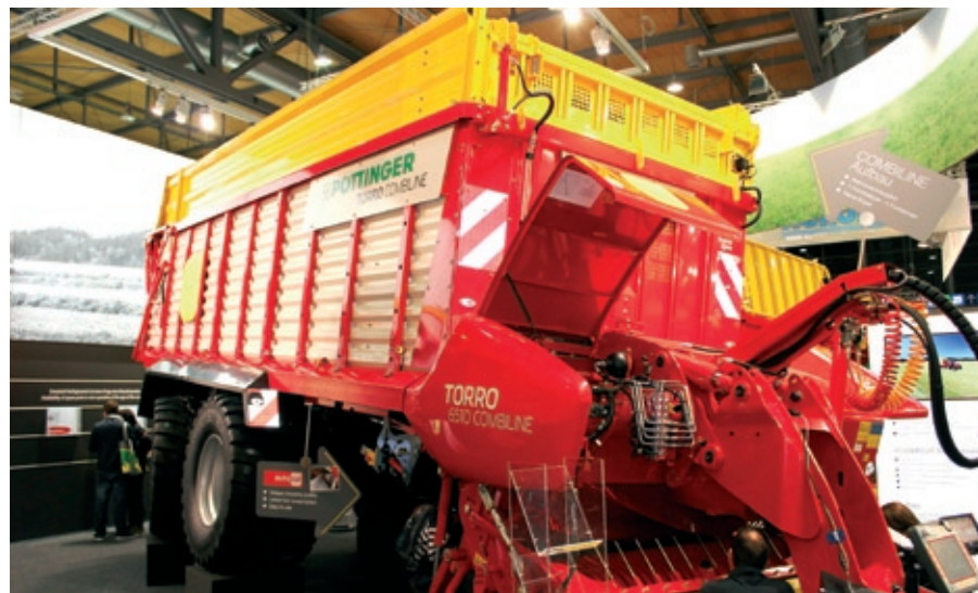
Návěs TORRO 6510 L COMBILINE prezentoval možnost výbavy automatickým broušícím zařízením AUTOCUT, které udržuje ostří nožů v nabroušeném stavu po celý den bez nutnosti vyjímání, což má pozitivní vliv na kvalitu řezanky i na snížení spotřeby paliva.
