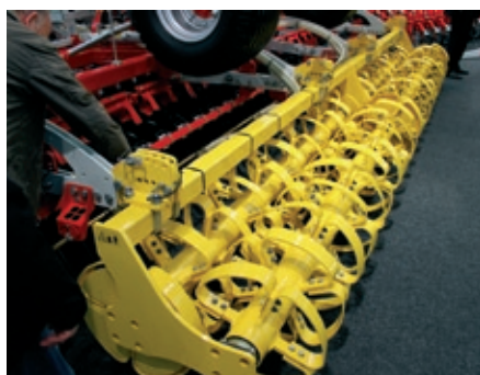
Podmiťáč TERRADISC 6001 T prezentoval nový typ zdvojeného kónického segmentového válce TANDEM CONOROLL, který vyniká vysokou nosností. Díky tomu je vhodný pro návěsná provedení strojů, u nichž zvyšuje přítlak na talíře ještě sklopený podvozek. Zešikmené tvarování jednotlivých segmentů podporuje samočistící funkci.
