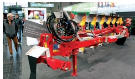
Oblíbené originální řešení u návěsných pluhů SERVO 6.50 – trakční posilovač TRACTION CONTROL, přichází do nové sezony v inovované podobě. Tlak v systému je při otáčení soupravy na souvratích snížen tak, aby nedocházelo k negativnímu ovlivňování stability traktoru.
