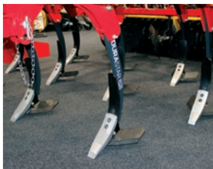
Jako reakci na extrémně obtížné půdní podmínky způsobené suchem v roce 2015 představila firma Pöttinger nové radličky DURASTAR PLUS. Oproti provedení DURASTAR nabízí další prodloužení životnosti a zachování kvality práce na konstantní úrovni po delší dobu.
