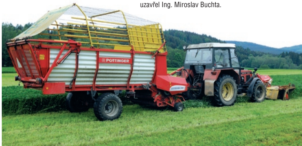
Sběrací vůz EUROBOSS 250 H v sestavě s čelní žací lištou NOVACAT 266 F po celou sezonu vozí čtyřikrát denně do silážního žlabu zelenou hmotu, kterou krmný vůz zpracuje do krmné dávky pro dojnice.
