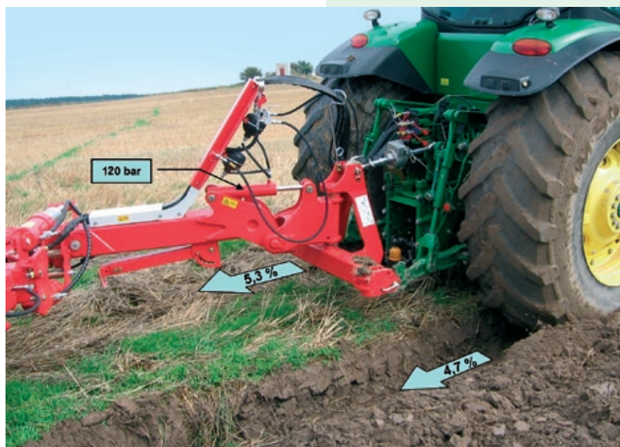
Při plovoucí poloze rozvaděče vnějšího okruhu hydrauliky je v hydraulickém válci prakticky nulový tlak. Hydraulický válec nepřenáší zatížení z pluhu na traktor. U záhonového kola byl naměřen průměrný prokluz 21,8 % a brzdového kola 6,5 %.
