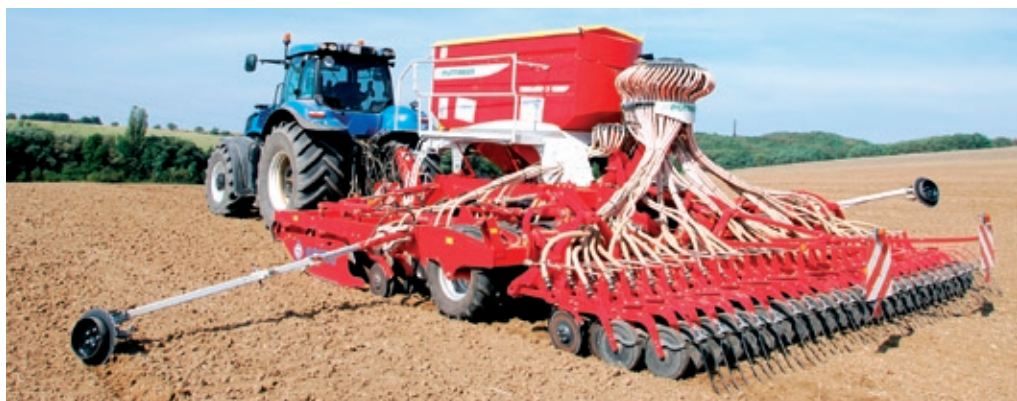
Stroj s príhnojovaním TERRASEM C6 FERTILIZER výborne kopíruje nerovnosti. Vybavený je presným dávkovacím systémom a dvojdiskovou výsevnou pätkou, ktorá garantuje uloženie osiva do požadovanej hĺbky.
