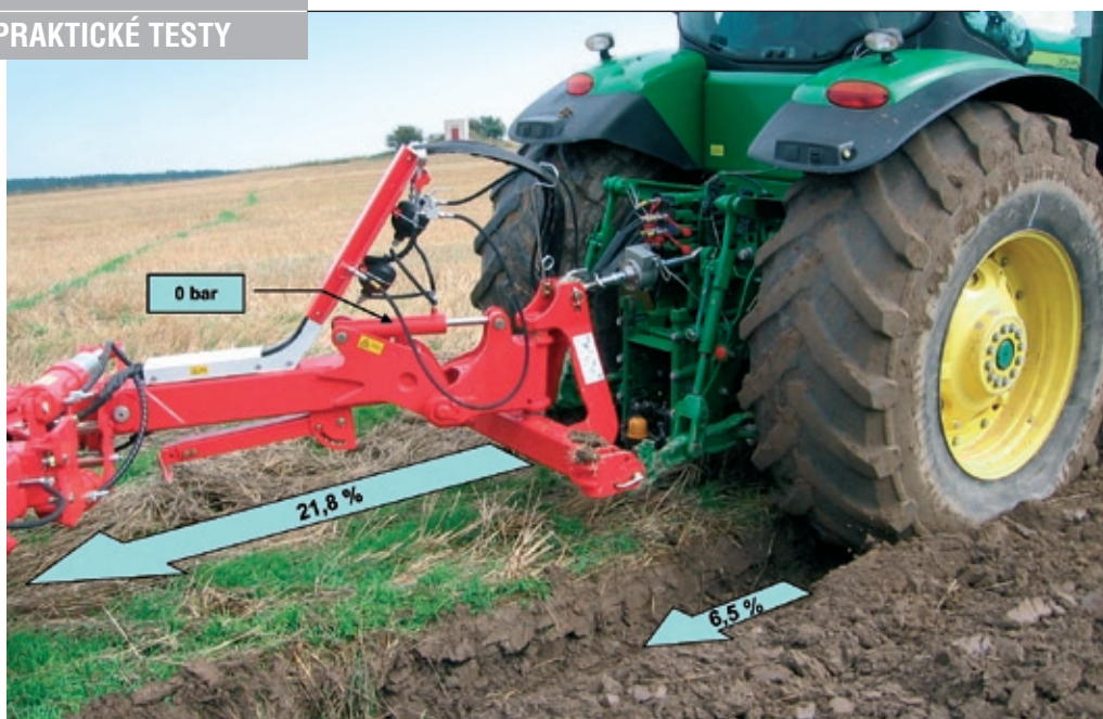
Při plovoucí poloze rozvaděče vnějšího okruhu hydrauliky je v hydraulickém válci prakticky nulový tlak. Hydraulický válec nepřenáší zatížení z pluhu na traktor. U záhonového kola byl naměřen průměrný prokluz 21,8 % a brzdového kola 6,5 %.
