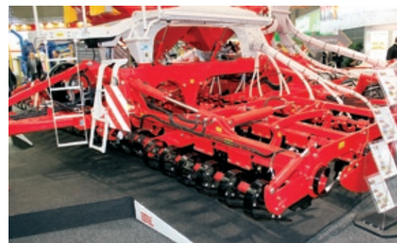
Pneumatické secí stroje TERRASEM C dokáží i s velkým záběrem až do 9 metrů dobře kopírovat pozemek díky výkvnému spojení bočních sekcí s talíři, opěrným a pojezdovým pneumatikovým válcem a sekcí secích botek.
