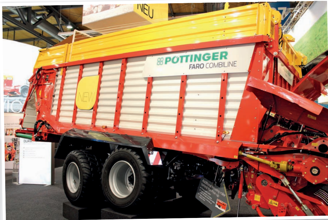
Návěs Faro 4010 D Combiline rozšiřuje řadu vozů Faro o robustnější vozy pro univerzální využití jak při sběru píce z řádku, tak i pro odvoz od řezačky do místa uložení
