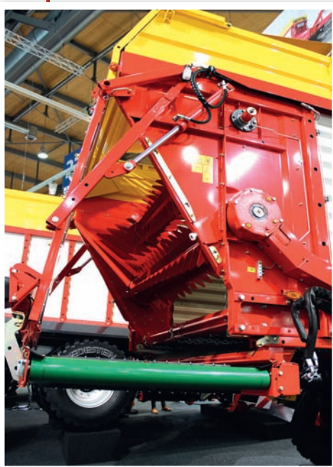
Návěs Faro 4010 D Combiline rozšiřuje řadu vozů Faro o robustnější vozy pro univerzální využití jak při sběru píce z řádku, tak i pro odvoz od řezačky do místa uložení
