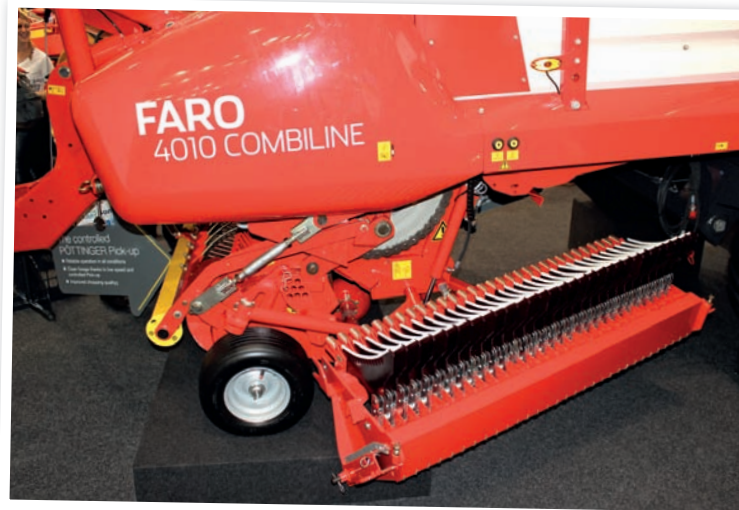
Návěs Faro 4010 Combiline může mít ve svém výkyvném nosníku nožů maximálně 31 nožů, s nimiž dosáhne teoretické délky řezanky 45 mm
