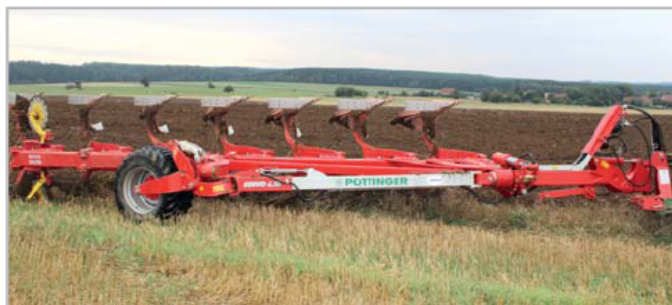
Systém Traction Control slouží k automatické regulaci tažné síly traktoru, a to při zachování nastavené hloubky orby. Při orbě dochází k tomu, že brázdové a záhonové kolo zadní nápravy traktoru je cíleně nerovnoměrně dotížované. Servo 6.50 Nova spolehlivě pracuje v podniku Zemspol Sloup od října 2013
