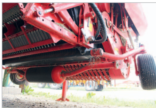
Šikovná inovace firmy Pöttinger, přidávaný snímávací váleček sběrače, se dobře uplatní na mokřích loukách. Díky němu pracují prsty sběrače stále v nastavené výšce, nadměrně se neopotřebovávají a návěs Jumbo 6610 L sklízí čistou hmotu
