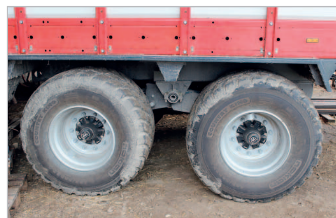
Tandemový podvozek je odpružený pomocí parabolických pružin pro maximální stabilitu. S pneumatikami na ráfcích o průměru 22,5 palce je vhodný i pro práci na svazích
