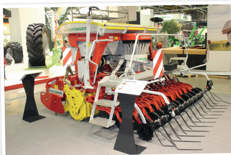
Firma Pöttinger se prezentovala též na mezinárodním veletrhu EIMA 2016 v Bologni. Vystavený secí stroj Aerosem 3002 ADD PCS byl vybaven výsevním ústrojím Precision Combi Seeding a inteligentní distribuční hlavicí IDS
