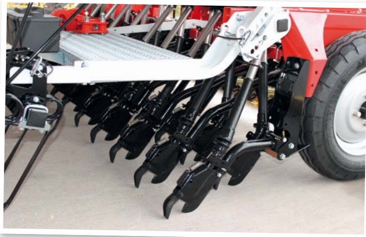
Secí stroje Vitasem mohou být osazeny také radličkovými botkami, vhodnými například k seti do lehkých půd
