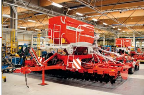
Montážní linka na stroje Terrasem má nově šířku deset metrů, takže dovoluje montovat bez problémů i stroje Terrasem C9 se záběrem devíti metrů
