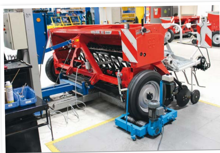
Kontrola kvality je samozřejmou součástí montáže. Také každý vyrobený mechanický secí stroj Vitasem prochází výstupní kontrolou, a to po dobu dvaceti minut; na obrázku ji podstupuje secí stroj Vitasem 302 classic s vlastním podvozkem
