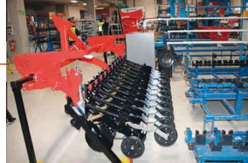
Po úspěšném ukončení testování je u secích strojů Aerosem zahrnutý do výroby držák výsevních botek z hliníku. U neseného stroje je zajiště významnou výhodou snížení hmotnosti
