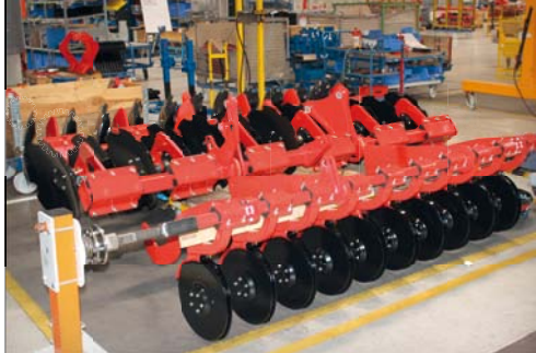
Secke dvoukotoučových výsevních botek a taliřových bran pro přípravu půdy pro secí stroje Terrasem se připravují v předmontáži. Následně jsou k secím strojům namontovány
