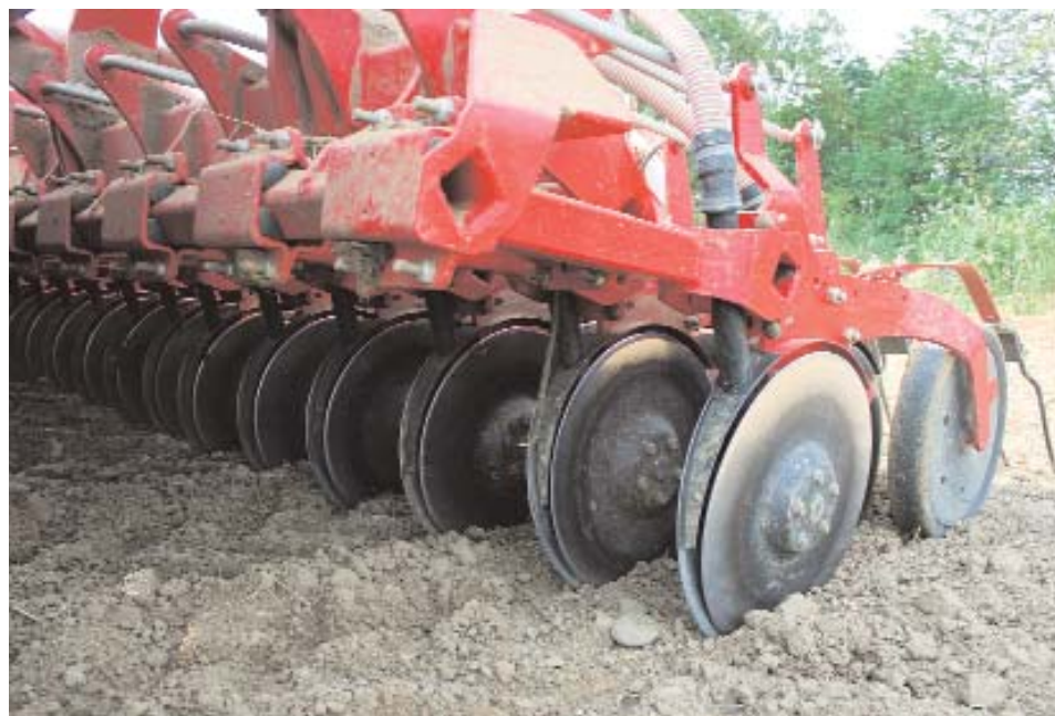
Kotoučové výsevní ústrojí si poradí i s posklizňovými zbytky
