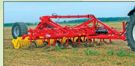
SYNKRO 5003 T – polonesené prevedenie, pracovný záber 5 m
