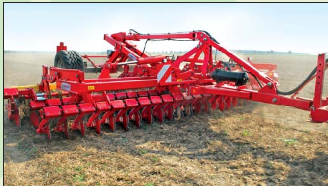
Terradisc 6000 T – polonesené prevedenie, pracovný záber 6 m
