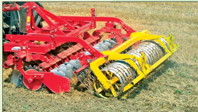
Terradisc 3000 – nesené prevedenie, pracovný záber 3 m
