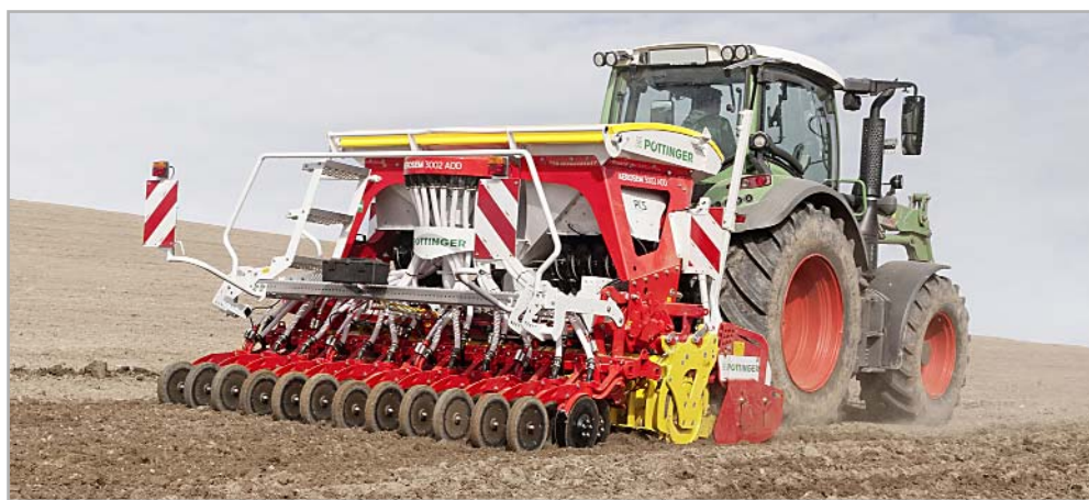
Firma Pöttinger znovu rozšiřuje možnosti využití svých nástavbových pneumatických secích strojů Aerosem ADD PCS o možnost výsevu kukuřice do dvouřádku
