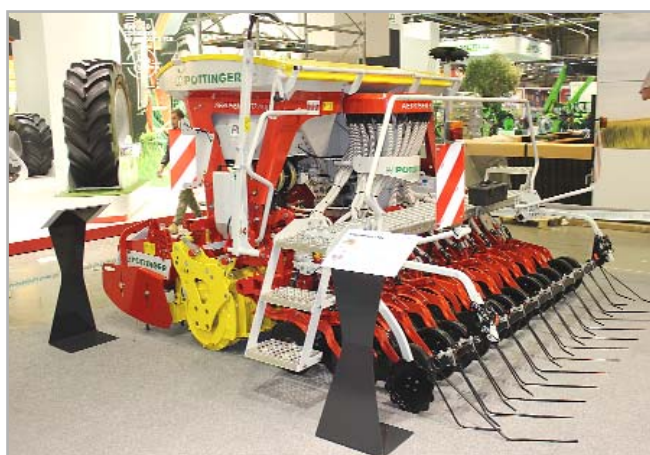
Firma Pöttinger se prezentovala též na mezinárodním veletrhu Eima 2016 v Bologni. Vystavený secí stroj Aerosem 3002 ADD PCS byl vybaven výsevním ústrojím Precision Combi Seeding a inteligentní distribuční hlavicí IDS
