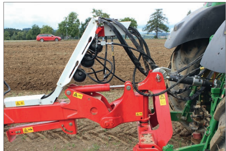
Firma Pöttinger vyřešila uložení hydraulických hadic na pluhu Servo 6.50 Plus Nova bezpečně: jsou umístěné v držáku, který je chrání před poškozením
