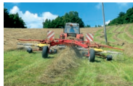
Tažený dvourotorový shrnovač EUROTOP 771 pro tvorbu středového řádku s pracovním záběrem 7,80 metru bude letos v provozu už sedmou sezónou.
