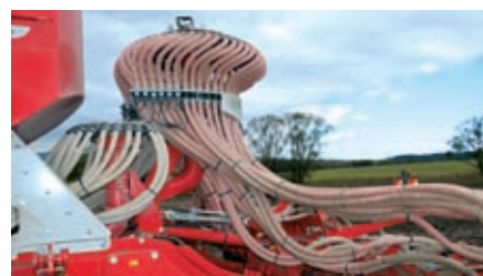
Rozdělovací hlavy pro hnojivo i osivo. Při tvorbě kolejových řádků se automaticky snižuje výsevek osiva. Secí stroj TERRASEM je s kontrolou průchodnosti v základní výbavě.
