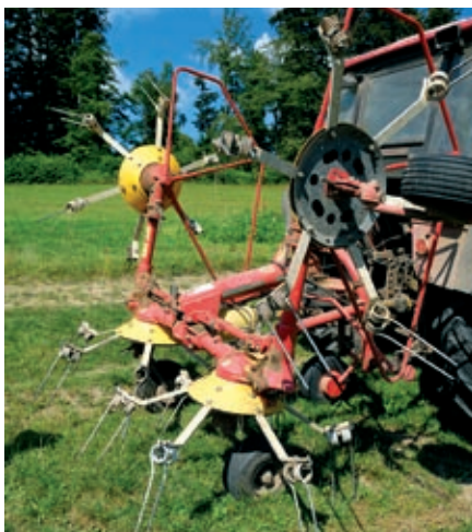
Čtyřrotorový obraceč EUROHIT 47 N z roku 2000 je stále funkční a v provozu spolehlivý.
