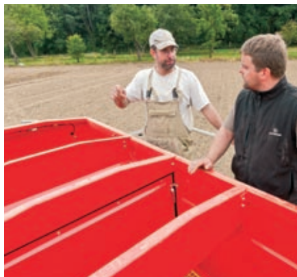
Velkoobjemový zásobník s přestavitelnou příčkou pro rozdělení osiva a hnojiva v poměru 60:40, 50:50 nebo 40:60. Snadno přístupný zásobník je vybavený mřížkou proti nečistotám nebo snímačem stavu naplnění.
