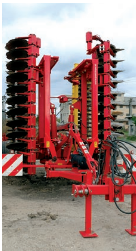
Polonesený sklopný diskový podmietač TERRADISC 6000 T s pracovným záberom 6 metrov.
