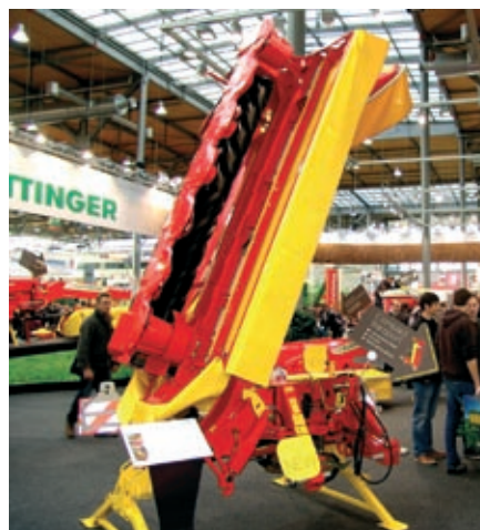
Novinkou je diskový žací stroj NOVACAT 302 RC s mačkacími válci.
