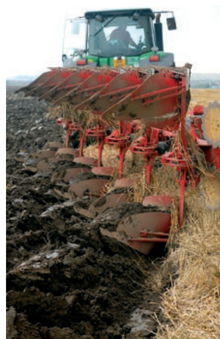
Na pozemku po sklizni ozimé pšenice jsme při přípravě pod řepku ozimou zastihli Michala Mitra s šestiradličním pluhem SERVO 6.50 NOVA v agregaci s traktorem 240 koní. Na poměrně rovné parcele o výměře 55 hektarů zpracovával půdu s velkým množstvím slámy do hloubky asi 20 cm, s výkonností kolem 14 až 15 hektarů za den a při průměrné spotřebě nafty do 20 litrů. Michal Mitro pracuje s pluhem třetí sezonu a každoročně s ním zpracuje asi 600 hektarů.
