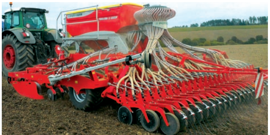
Sejací stroj TERRASEM C6 fertilizer pracuje v PD Mlynica druhú sezónu. Miroslav Krempaský, ktorý ho obsluhuje, oceňuje presné nastavenie, vynikajúcu priechodnosť, spätné utuženie aj vo vlhkých podmienkach, čo je výhoda oproti iným strojom a prihnojovanie pri sejbě znamená dve operácie jedným prejazdom.
