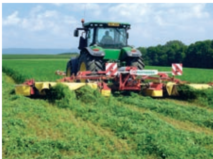
Žací kombinace NOVACAT X8 RC se záběrem 8,30 metru s mačkacími válci, na kterou bezprostředně navazuje nový tažený desetitorový obraceč HIT 10.11 T (dolní snímek). Zavadlou píci potom shrnou do stranových řádků dvourotorové shrnovače – EUROTOP 851 nebo letos pořízený TOP 812, oba s pracovním záběrem přes 8 metrů.
