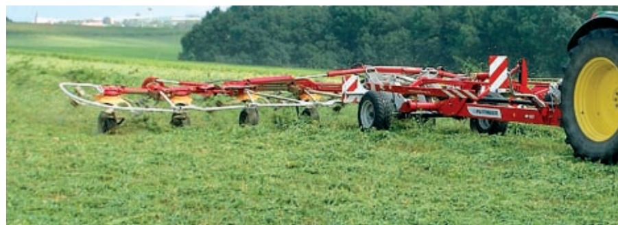
Obraceč HIT 10.11 T s pracovním záběrem 11 metrů spolehlivě pracuje v agregaci s traktorem 90 nebo 120 koní. Přepravní šířka je pod 3 metry, přičemž přepravní podvozek má funkci čelního kopírovacího kolečka. Vybavený je rotory DYNATECH, které kvalitně obracejí hmotu, jsou stabilní, mají speciální konstrukci ramen, aby se stébla nezachytávala na stroji.
