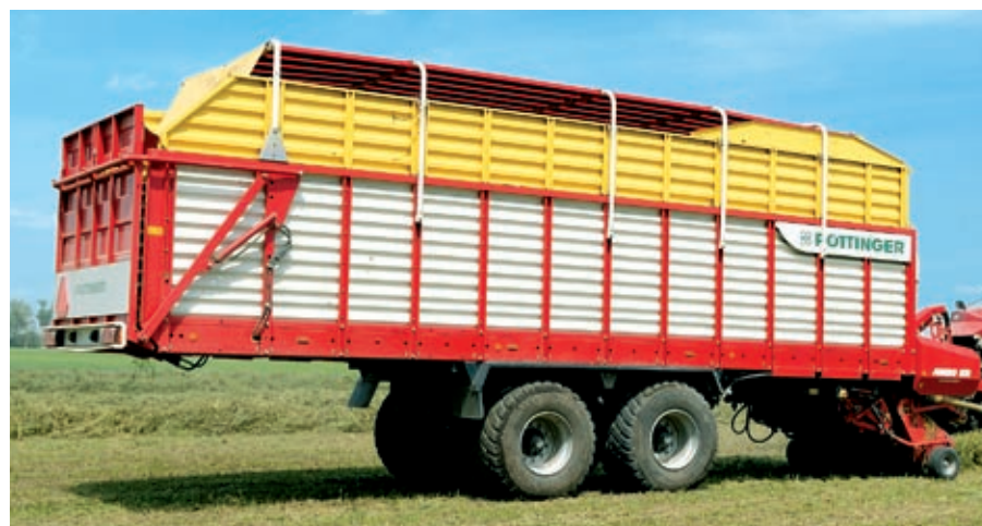
Senážny voz JUMBO 8010 L s objemom 80 m 3 dovoľuje bez problémov zberať 3 hektáre za hodinu. Vybavený je automatickým zariadením na brúsenie nožov AUTOCUT, ktoré šetrí čas na brúsenie nožov.
