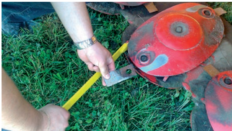
Diskový žací stroj s rychloupínáním nožů vyžaduje minimální nároky na údržbu.
