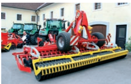
Nová generace podmičáču TERRADISC řady 1001 má nejen pracovní orgány o větším průměru, ale v návěsném provedení také podvozek sklápěný tak, že v pracovní poloze dotěžuje pole talířů.
