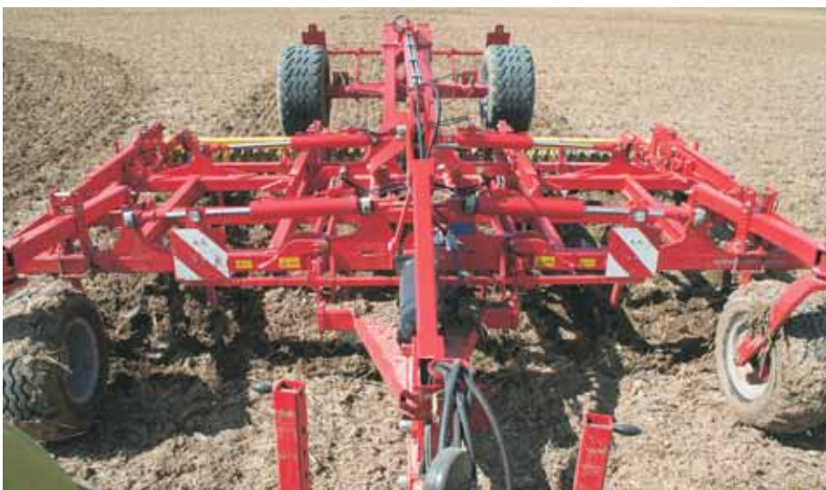
Mit groß bereiftem Fahrwerk und Bremse wiegt der Synkro 5003 T immerhin 5480 kg (Messwert Testmaschine). Traktoren ab 220 PS sollten vorgespannt werden.
