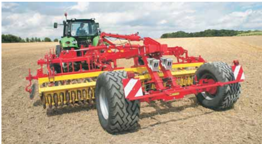
Das T-Fahrwerk ist stabil und gut verarbeitet. Durch die hinten platzierte Achse ist die Wendigkeit nicht überragend. Gleichzeitig ist die Werkzeugabfolge vorne dicht beisammen.
