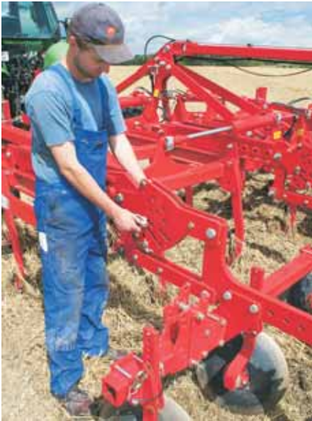
Die Lochkulisse verstellt die Arbeitstiefe mit einem Parallelogramm. Die Hohl-scheiben bewegen sich in der Position mit.
