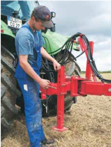
Gut: Über die beiden stabilen Stützen wird die Traverse beim Abstellen gut fixiert. Das erleichtert das An- und Abkuppeln.
