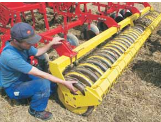
Der 550-mm-Schneidpacker trägt bei trockenen Bedingungen gut. Mehr Durchmesser wäre gut. Die Walze ist wartungsfrei und die Abstreifer nachstellbar.
