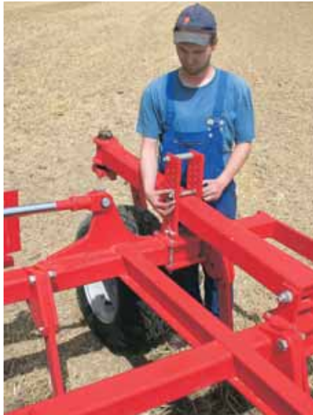
Gut: Die Stützräder vorne fallen groß aus (13.0/55-16, Option) und sind lenkbar. Die Tiefenverstellung geht einfach per Bolzen.
