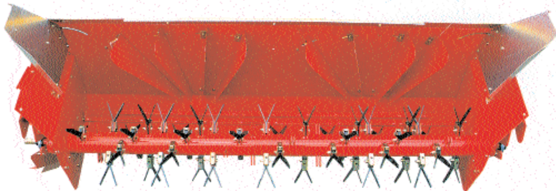
Obr. 2 Princip práce lamače se zařízením Extra dry je založen na nastavitelných směrovacích plechách
