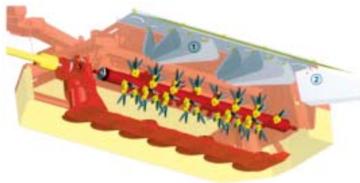
Čechrací rotor: 1 – směrovací lamely, 2 – usměrňovací plech pro tvarování řádku, 3 – pohon rotoru čechrače
