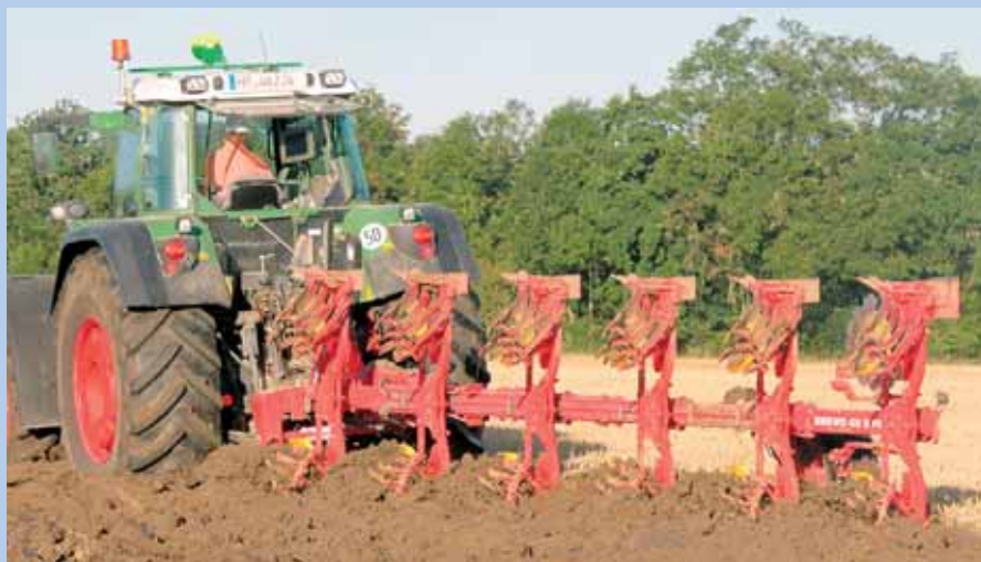
Die 38-WWS-Körper legen ein sauberes Pflugbild hin. Hub- und Zugkraftbedarf für den großen Servo 45 S fordern Traktoren ab 220 PS. Bis 10 km/h und 2,5 ha/h sind drin.
