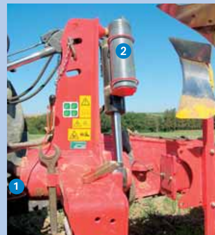
Die Hydraulikschläuche laufen durch die 150-mm-Drehwelle (1). In der Rohrbox (2) finden Scherbolzen und Werkzeug Platz.
