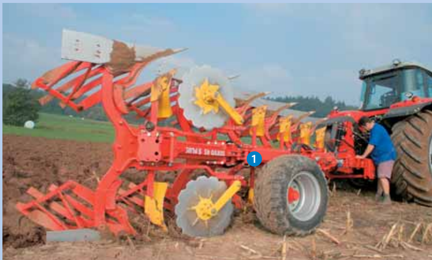
Die Klemmbacken (1) der Sechsscheibhalterung haben sich im Praxiseinsatz immer wieder gelockert. Der Verschleiß (nur Scharblätter, nach 92 ha) geht mit 5,90 €/ha in Ordnung,
