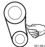
Kettenspannung mit dem Daumen am Prüfpunkt (PP1) kontrollieren. Spiel: 3,5 - 5mm
