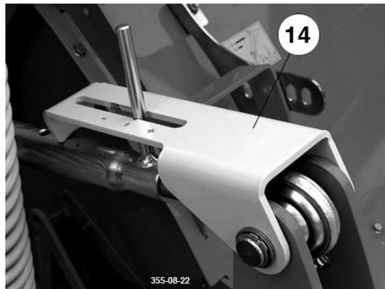
Die Klappe (14) dient als Schnitthöhenanzeige und als Verdrehsicherung.
