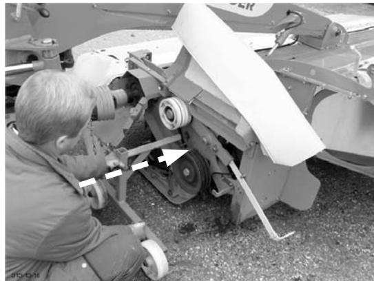
12. Spannhebel (4) entfernen
