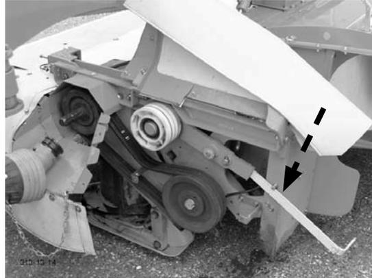
9. Déposer les courroies
