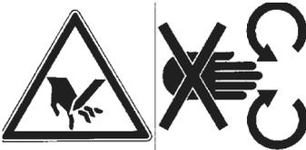
Während des Betriebes Schutzvorrichtungen nicht öffnen oder entfernen.
