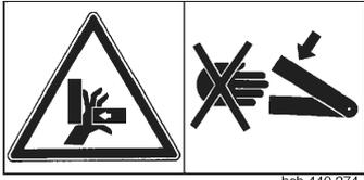
Ne pas s'approcher de la zone de danger par écrasement, aussi longtemps que des pièces y sont encore en mouvement.
