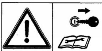
Vor Wartungs- und Reparaturarbeiten Motor abstellen und Schlüssel abziehen.
