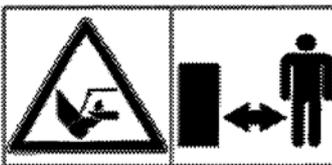
Bei eingeschaltetem Antrieb und laufendem Traktormotor ausreichend Abstand zum Mähmesser halten.
