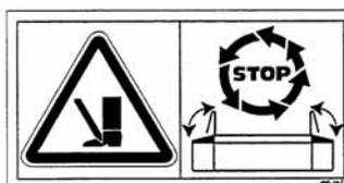
Vor dem Einschalten der Zapfwelle beide Seitenschutze schließen.
