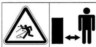
Gefahr durch fortgeschleuderte Teile bei laufendem Motor - Sicherheitsabstand halten.
