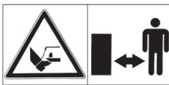
Garder une distance suffisante des couteaux si le moteur tourne et que la prise de force est branchée.
