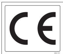
Le sigle CE apposé par le constructeur atteste que la machine est en conformité avec les spécifications de la machine et avec d'autres directives européennes.
