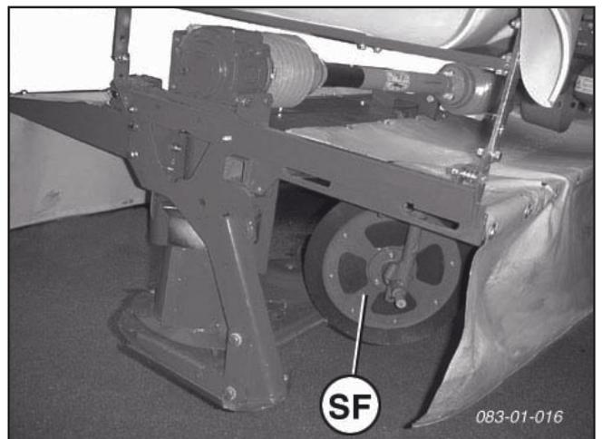
**7. Schutzblech montieren (5) (nur bei den seitlichen Mähwerken)**
