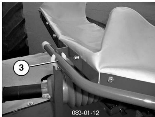
**3. Riemenschutz (2) entfernen ( Front-Mähwerk)**
