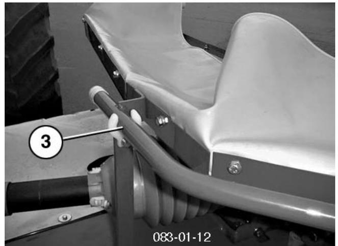
3. Retirer la protection de courroie (15) ( faucheuse frontale)
