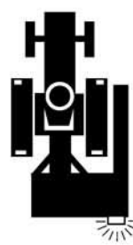
Arbeitsgeräte mit Dreipunktanbau müssen mit einer eigenen Beleuchtungseinrichtung ausgerüstet sein:
