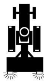
Arbeitsgeräte mit Dreipunktanbau müssen mit einer eigenen Beleuchtungseinrichtung ausgerüstet sein:
