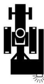
Arbeitsgeräte mit Dreipunktanbau müssen mit einer eigenen Beleuchtungseinrichtung ausgerüstet sein:
