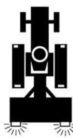
Arbeitsgeräte mit Dreipunktanbau müssen mit einer eigenen Beleuchtungseinrichtung ausgerüstet sein:
