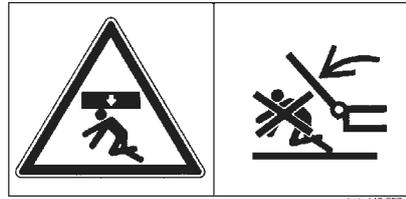
Ne pas stationner à proximité des pièces en mouvement.
