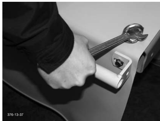
2. Schutz vorne manuell hochschwenken. Der Schutz verriegelt in dieser Position.
