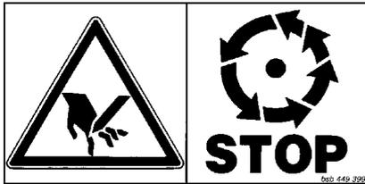
Ne touchez aucune pièce de la machine en rotation. Attendre l'arrêt complet de la machine.
