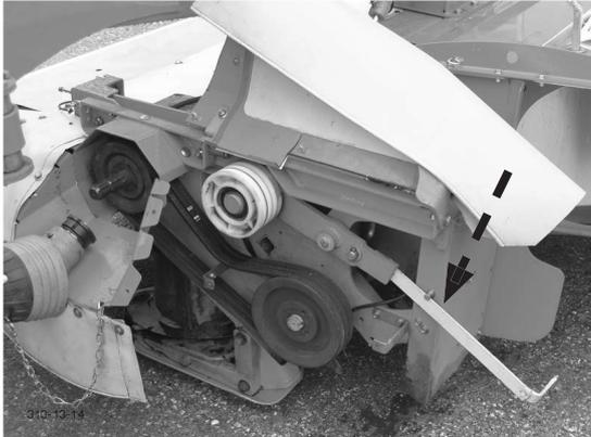
9. Déposer les courroies
