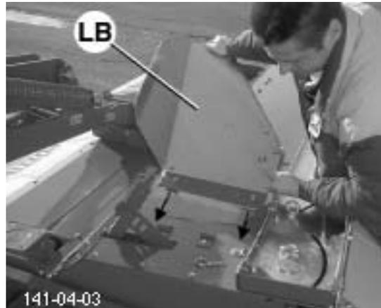
Wird eine größere Streubreite gewünscht kann das Leitblech demontiert werden.
