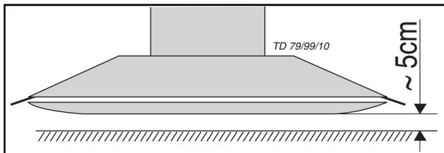
2. Monter la clé (W) sur la vis à 4 ou 6 pans et la tourner jusqu'à obtention de la hauteur souhaitée.
