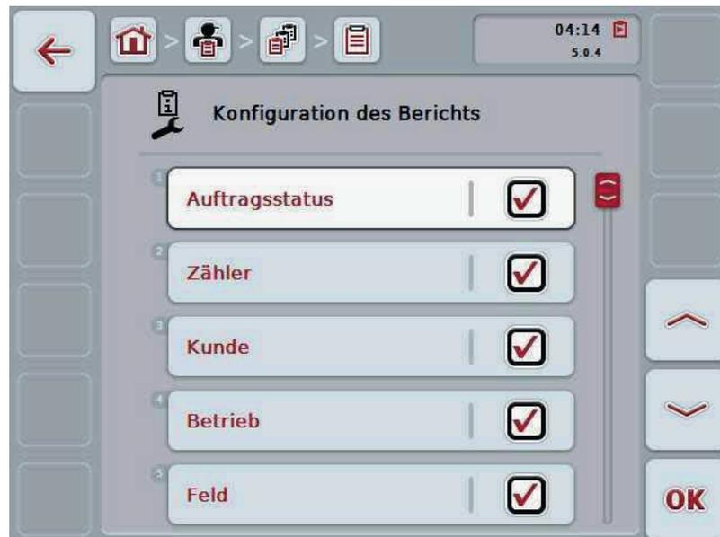
2. Wählen Sie die Parameter aus, die im Auftragsbericht angezeigt werden sollen. Drücken Sie hierzu im Touchscreen auf den Parameter oder drehen Sie am Scrollrad, bis die Schaltfläche weiß markiert ist, und drücken Sie dann auf das Scrollrad.
