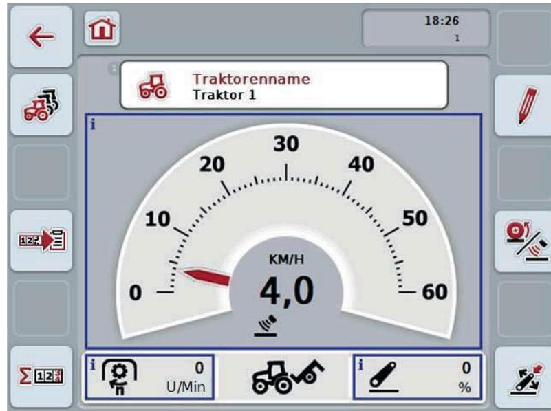
Wenn alle Signale über den ISOBUS gelesen und bereitgestellt werden ist eine Verbindung mit der Signalsteckdose nicht erforderlich
