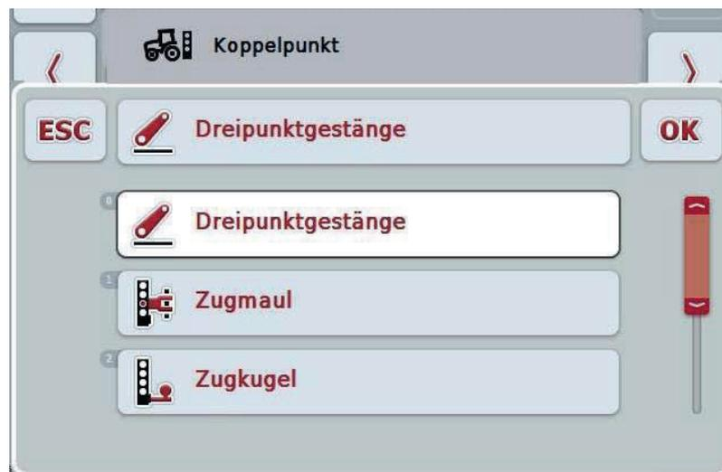
2. Wählen Sie in der Auswahlliste die gewünschte Anbauart aus. Drücken Sie hierzu im Touchscreen auf die Schaltfläche mit der Anbauart oder drehen Sie am Scrollrad, bis die Schaltfläche weiß markiert ist. Die Anbauart erscheint dann im Auswahlfenster.
