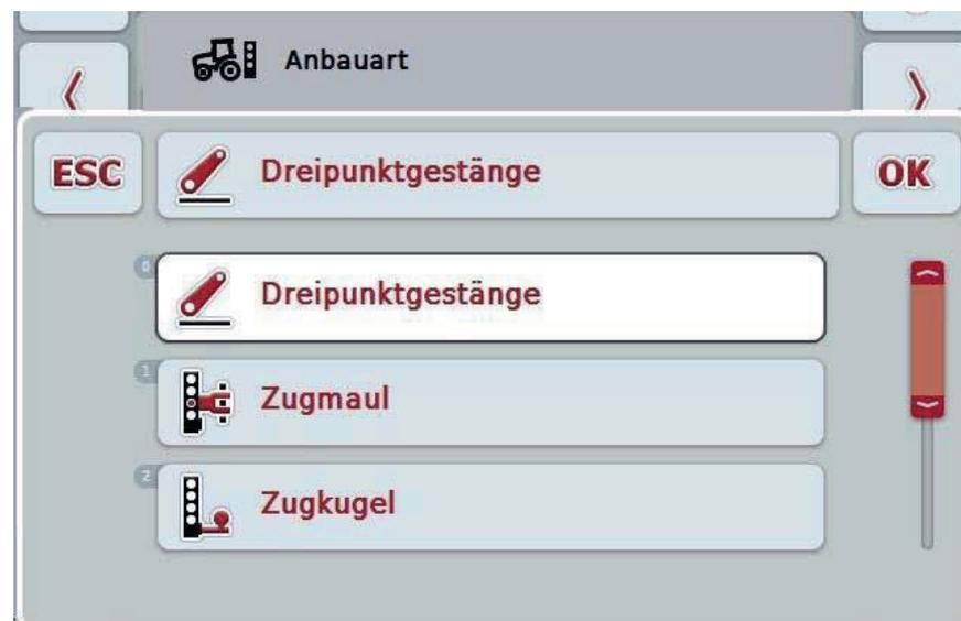
2. Wählen Sie die aktuelle Anbauart der Maschine aus der Liste aus. Drücken Sie hierzu im *Touchscreen* auf die Schaltfläche mit der Anbauart oder drehen Sie am Scrollrad, bis die Schaltfläche weiß markiert ist, und drücken Sie dann auf das Scrollrad.
