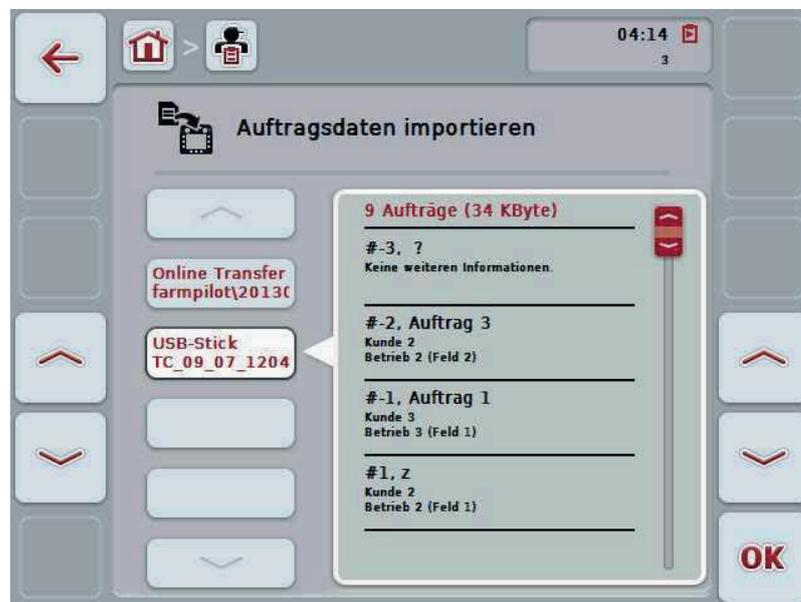
4. Wählen Sie die Auftragsdatei aus, die importiert werden soll. Drücken Sie hierzu im Touchscreen auf die Schaltfläche mit der Auftragsdatei oder wechseln Sie mit den Schaltflächen „Nach oben“ (F10) und „Nach unten“ (F11) zwischen den Auftragsdateien oder drehen Sie am Scrollrad, bis die Schaltfläche weiß markiert ist, und drücken Sie dann auf die Schaltfläche „OK“ (F6).
