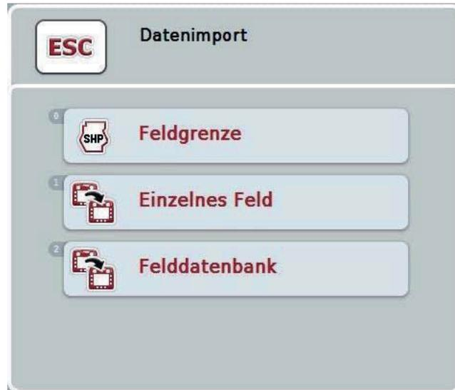
4. Wählen Sie die Option „Einzelnes Feld“ oder „Felddatenbank“. Drücken Sie hierzu auf die Schaltfläche mit der gewünschten Auswahl oder drehen Sie am Scrollrad, bis die Schaltfläche weiß markiert ist, und drücken Sie dann auf das Scrollrad.
