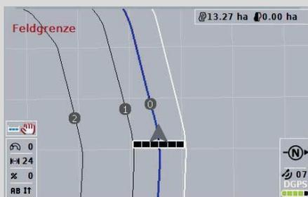
Im Vorgewende werden *Leitspuren* angezeigt. Referenz für diese *Leitspuren* ist die Feldgrenze. Das Vorgewende steht zur Bearbeitung zur Verfügung.
