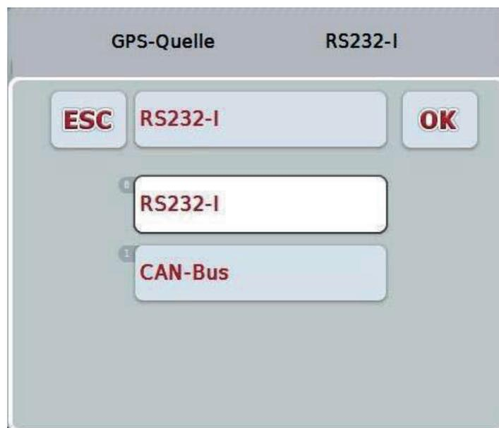
2. Wählen Sie in der Auswahlliste die gewünschte GPS-Quelle aus. Drücken Sie hierzu im Touchscreen auf die Schaltfläche mit der GPS-Quelle oder drehen Sie am Scrollrad, bis die Schaltfläche weiß markiert ist. Die GPS-Quelle erscheint dann im Auswahlfenster.
