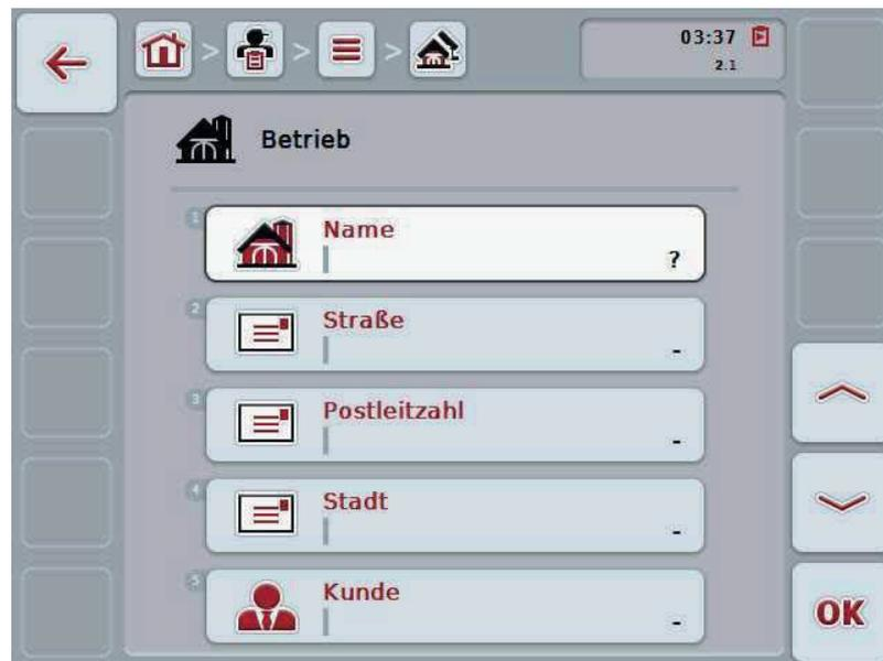
2. Wählen Sie in der Bedienmaske der Reihe nach alle Parameter aus. Drücken Sie hierzu im Touchscreen auf den Parameter oder drehen Sie am Scrollrad, bis die Schaltfläche weiß markiert ist, und drücken Sie dann auf das Scrollrad.
