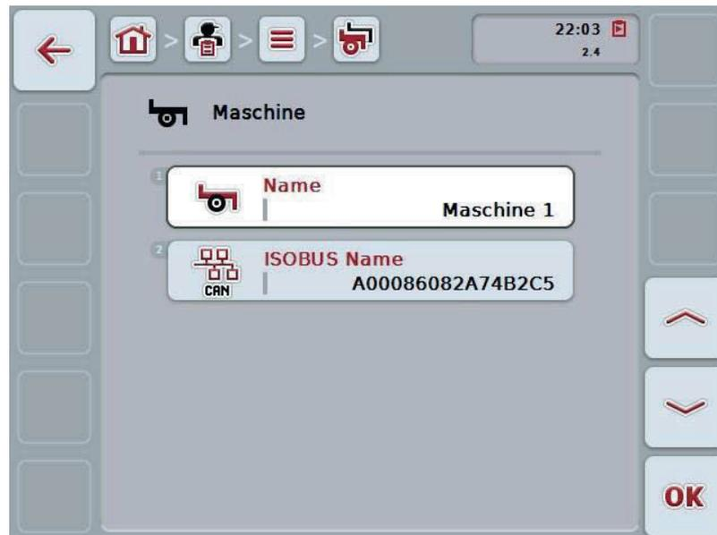
3. Wählen Sie in der Bedienmaske den Parameter aus, dessen Wert geändert werden soll. Drücken Sie hierzu im Touchscreen auf den Parameter oder drehen Sie am Scrollrad, bis die Schaltfläche weiß markiert ist, und drücken Sie dann auf das Scrollrad.
