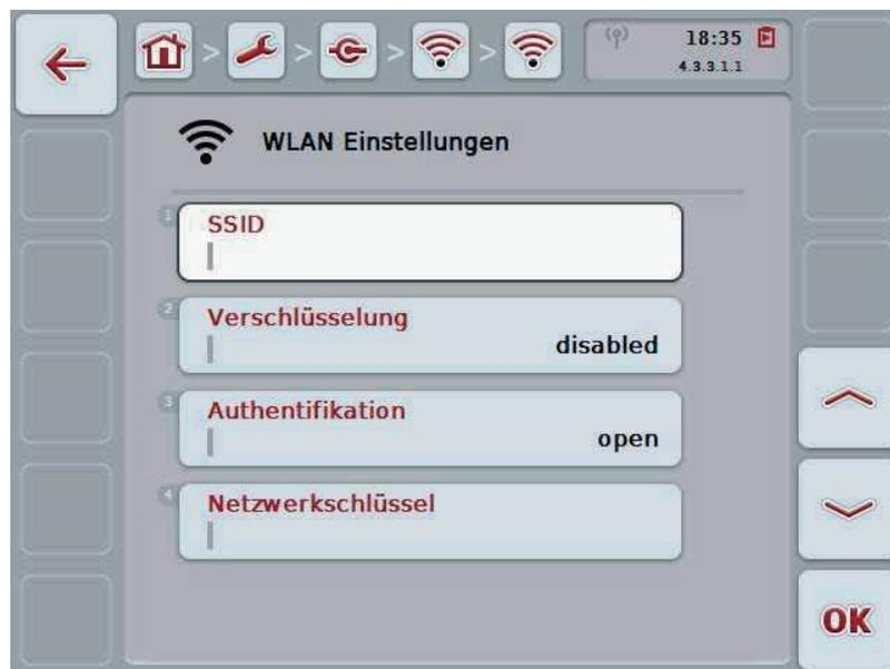
2. Wählen Sie in der Bedienmaske der Reihe nach alle Parameter aus. Drücken Sie hierzu im Touchscreen auf den Parameter oder drehen Sie am Scrollrad, bis die Schaltfläche weiß markiert ist, und drücken Sie dann auf das Scrollrad. Wenn die Schaltfläche markiert ist, können Sie alternativ auch auf die Schaltfläche „OK“ (F6) drücken.
