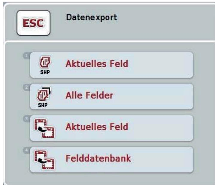
2. Wählen Sie zwischen „Aktuelles Feld“ oder „Felddatenbank“. Drücken Sie hierzu auf die Schaltfläche mit der gewünschten Auswahl oder drehen Sie am Scrollrad, bis die Schaltfläche weiß markiert ist, und drücken Sie dann auf das Scrollrad.
