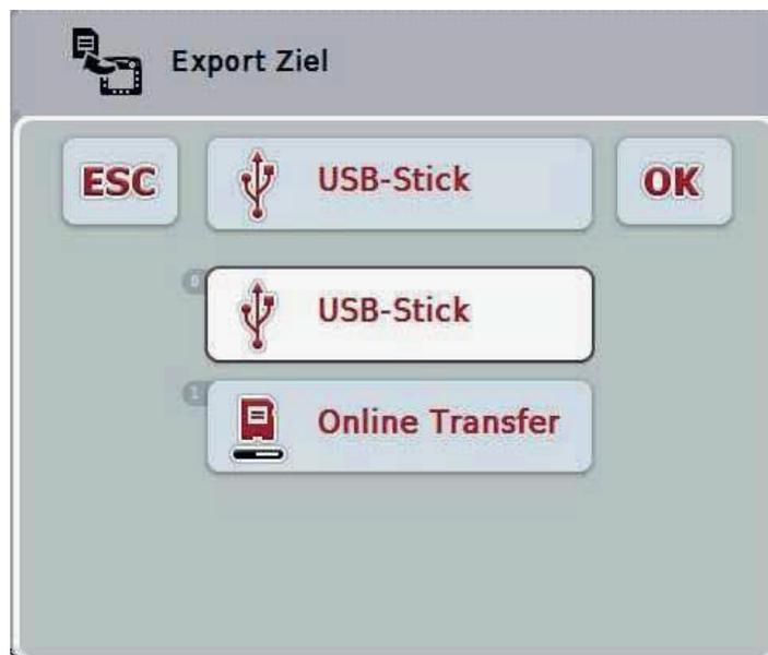
2. Wählen Sie zwischen „USB-Stick“ und „Online Transfer“. Drücken Sie hierzu im Touchscreen auf die Schaltfläche mit dem gewünschten Übertragungsweg oder drehen Sie am Scrollrad, bis die Schaltfläche weiß markiert ist, und drücken Sie dann auf das Scrollrad.
