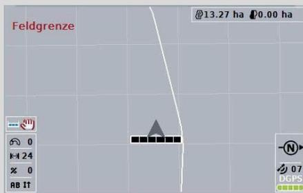
Die hellgraue Fläche wird nicht angezeigt. Das Vorgewende steht zur Bearbeitung zur Verfügung, die Teilbreiten werden dort nicht abgeschaltet.
