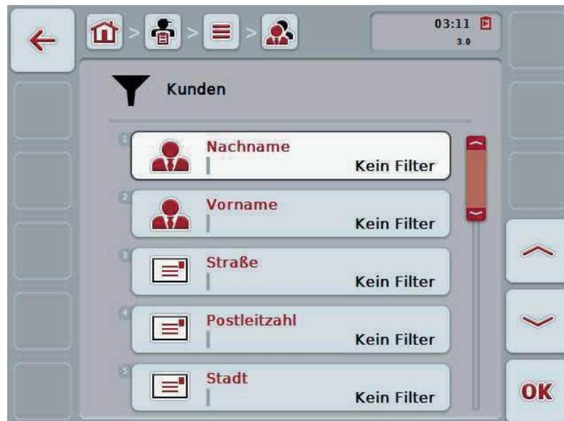
2. Wählen Sie das Kriterium aus, nach dem Sie die Liste filtern möchten. Drücken Sie hierzu im Touchscreen auf die Schaltfläche mit der Angabe oder drehen Sie am Scrollrad, bis die Schaltfläche weiß markiert ist, und drücken Sie dann auf das Scrollrad oder auf die Schaltfläche „OK“ (F6).
