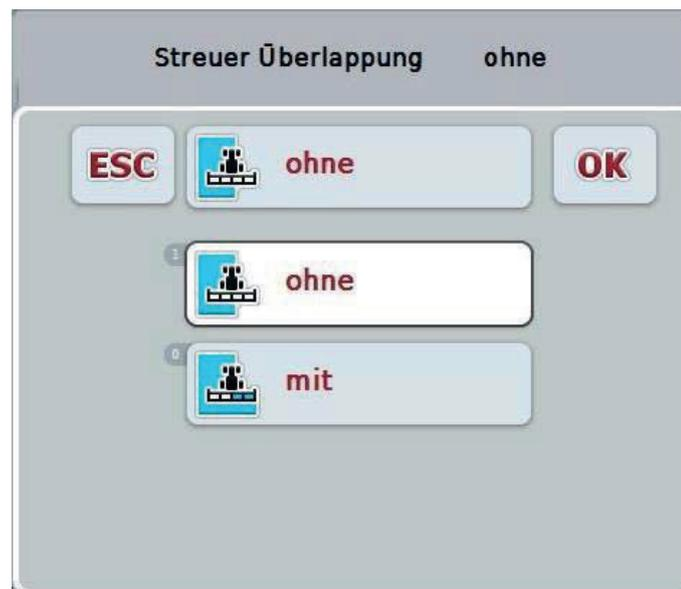
4. Wählen Sie die gewünschte Einstellung aus der Liste aus. Drücken Sie hierzu im *Touchscreen* auf die Schaltfläche „mit“ oder „ohne“ oder drehen Sie am Scrollrad, bis die Schaltfläche weiß markiert ist, und drücken Sie dann auf das Scrollrad.
