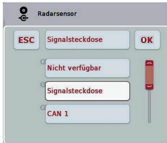
2. Wählen Sie die gewünschte Signalquelle aus. Drücken Sie hierzu im Touchscreen auf die Schaltfläche mit der Signalquelle oder drehen Sie am Scrollrad, bis die Schaltfläche weiß markiert ist, und drücken Sie dann auf das Scrollrad.
