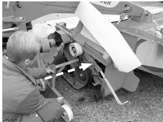
11. Spannhebel (4) entfernen
