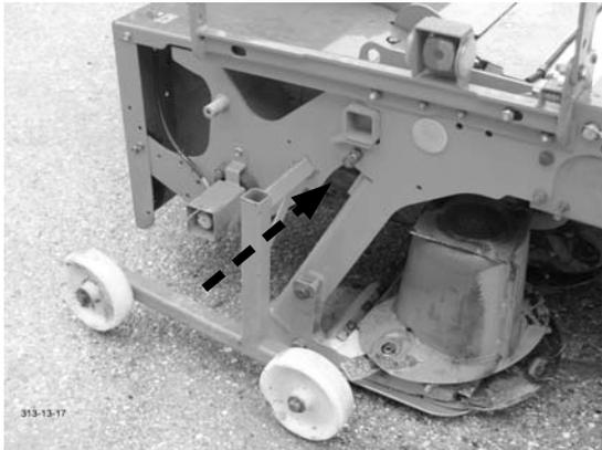
14. Befestigungen links und rechts lösen
