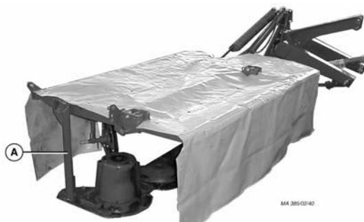
Se in condizioni d'uso difficili (ad es. erba molto alta, bassa velocità di guida, falciatura in pendenza) l'asta causa disturbi (accumulo di raccolto) la si può rimuovere nei tipi Nova Disc 225 e 265. Bei modelli 305, 350 e 400 ciò non è ammesso!
